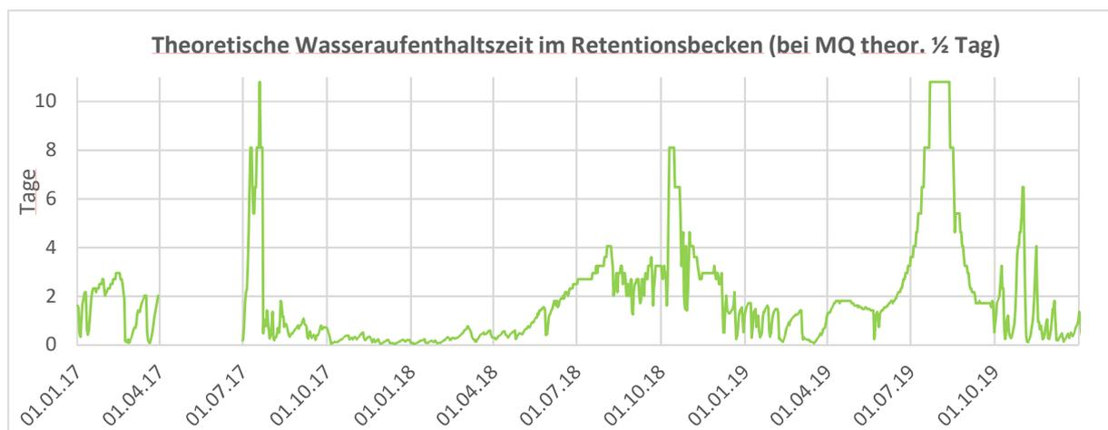
Abb. 7: Theoretische Wasseraufenthaltszeiten (Tage) im Retentionsbecken
