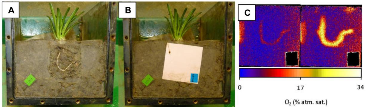
Abb. 31: *Lobelia dortmanna*-Pflanze mit zu untersuchender Wurzel in einem geöffnetem Aquarium (Rhizobox; A) und mit der vor der Wurzel platzierter O<sub>2</sub>-sensitiver Folie (B) sowie 2D-Bilder der Konzentration von O<sub>2</sub> (% atm. sat.) in der Rhizosphäre von *Lobelia dortmanna* im Dunkeln (links) und im Licht (rechts; C). Fotos: Nikola Lenzewski. Grafik C: Lenzewski et al. 2018b; verändert).
