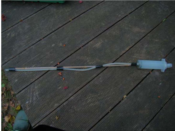
**Abbildung 1:** Gerät zur Aufnahme von Aufwuchsdiatomeen von Sedimentauflagen (Sand und Mudde) im Flachwasserbereich.
