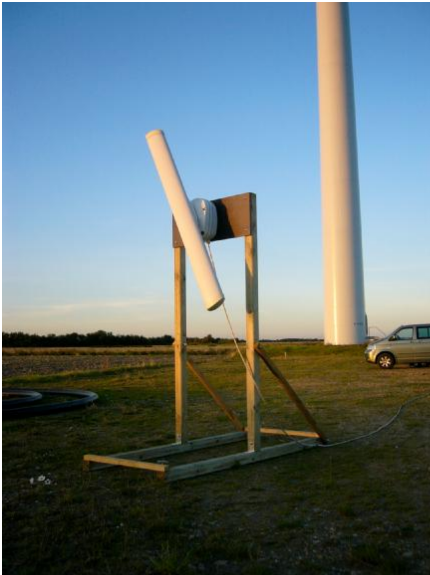
Abb. 37: Vertikal montiertes zehn kW-Schiffsradar im Simonsberger Koog am 10. September 2004.
