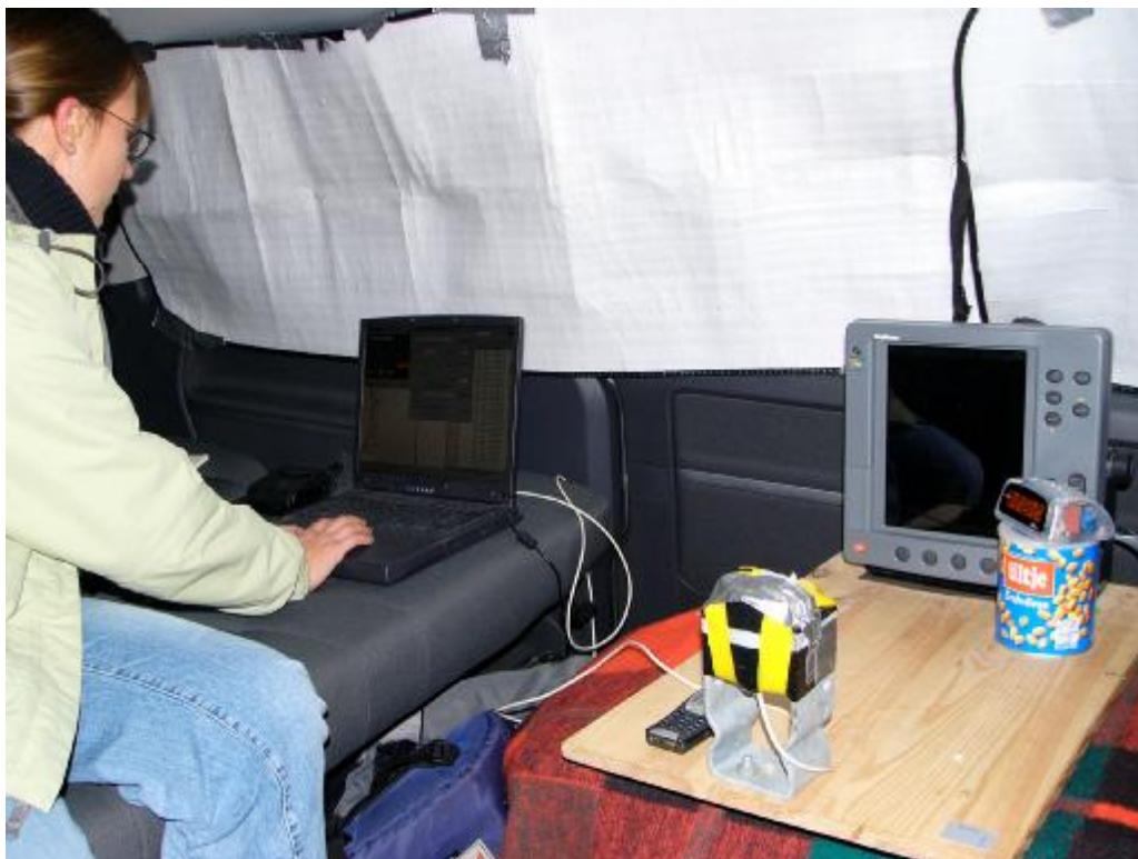
Abb. 40: Aufbau der Datenspeicherung mit Radarbildschirm, Uhr, Webcam und Laptop.
