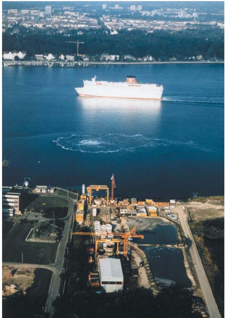
Abbildung 3: Der weiße Luftausstritt in der Förde kennzeichnet den Bauzustand des Tunnels bei 270 m Vortrieb in 33 m Tiefe
