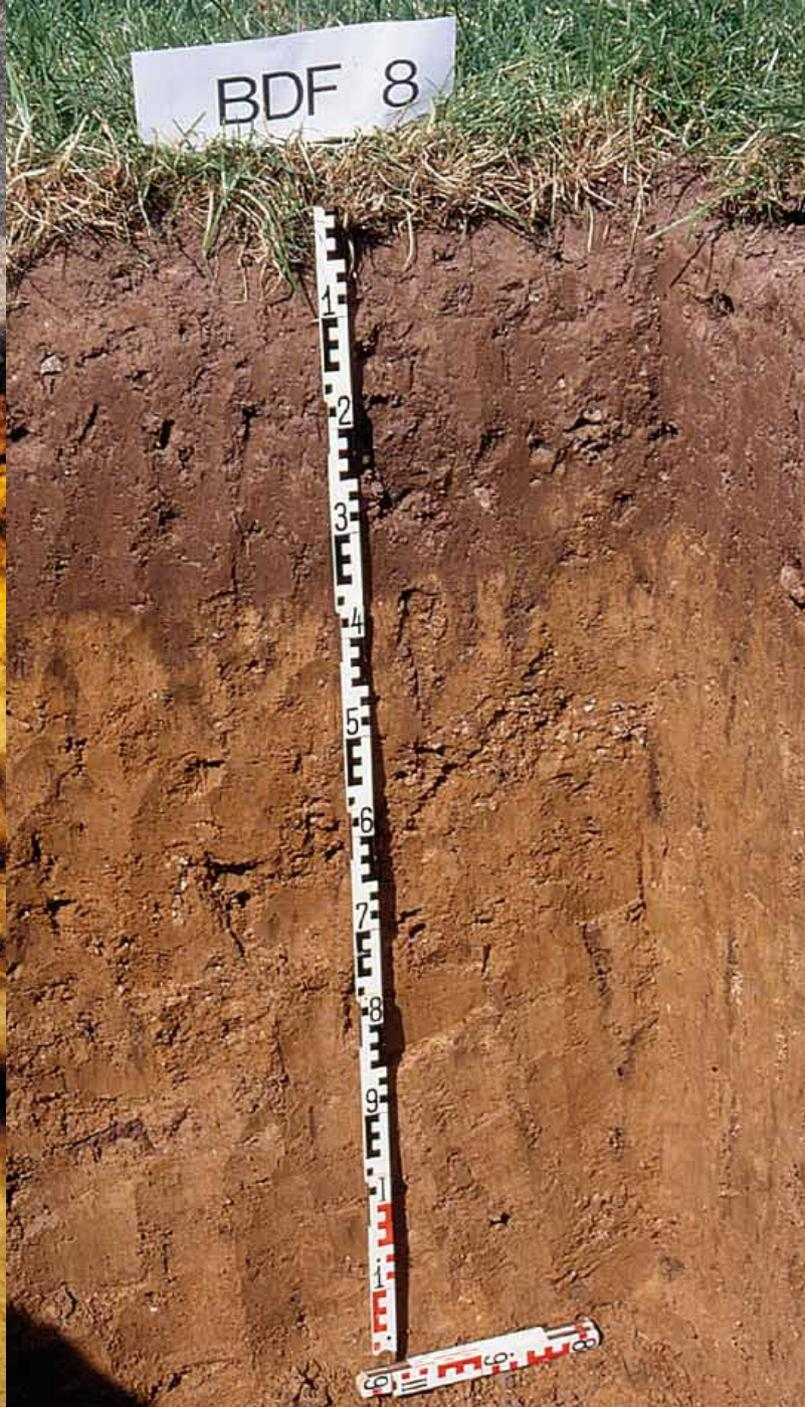
**BDF 08** Havetoftloit, Bodentyp: Parabraunerde, Ausgangsmaterial: Geschiebelehm über Geschiebemergel, Nutzung: Grünland
