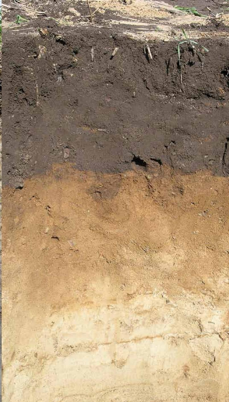
**BDF 23** Bokhorst, Bodentyp: podsolierte Braunerde, Ausgangsmaterial: Geschiebedecksand über Schmelzwassersand, Nutzung: Acker
