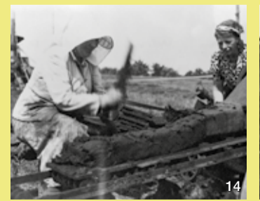
Bei der Bocktorfgewinnung wurde der von den Männern per Hand oder mit Hebmachines gelöste Torf in einem Trog zerkleinert, dann in Formen gepresst, in längere Stücke geschnitten und zum Trocknen aufgestapelt.
