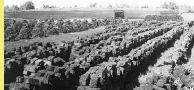
Bei der Bocktorfgewinnung wurde der von den Männern per Hand oder mit Hebmachines gelöste Torf in einem Trog zerkleinert, dann in Formen gepresst, in längere Stücke geschnitten und zum Trocknen aufgestapelt.
