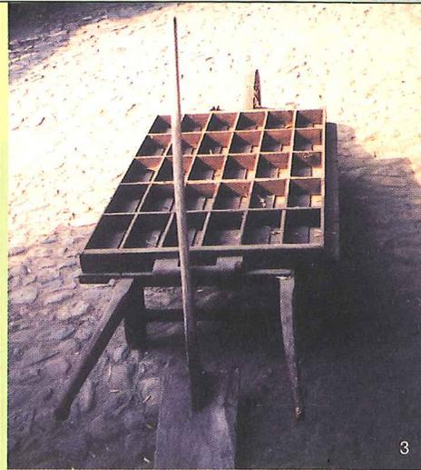
Anschließend karrten Moorarbeiter den Brei mit einer speziellen Moorkarre aus. Auf der Karre lag eine Torfform mit Kästen für 30 Stück Torf. Der Brei wurde in die Form geschaufelt und zum Schluss glatt abgestrichen. Nach dem Trocknen hatte man so einen sehr harten, festen Brennstoff mit Brikettqualität.
