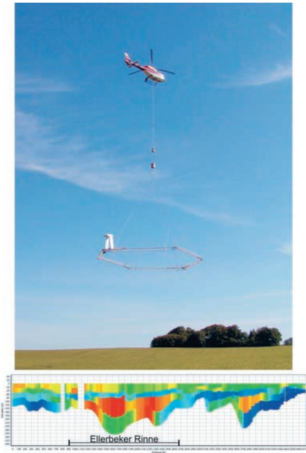
Abbildung 9: Aeroelektromagnetik, Messsystem SkyTEM, Helikopter mit Messapparatur Farbkodierung: rot, gelb, orange – überwiegend sandige Schichten (hoher elektrischer Widerstand); blau und grün – überwiegend tonige, schluffige Schichten (geringer elektrischer Widerstand)
