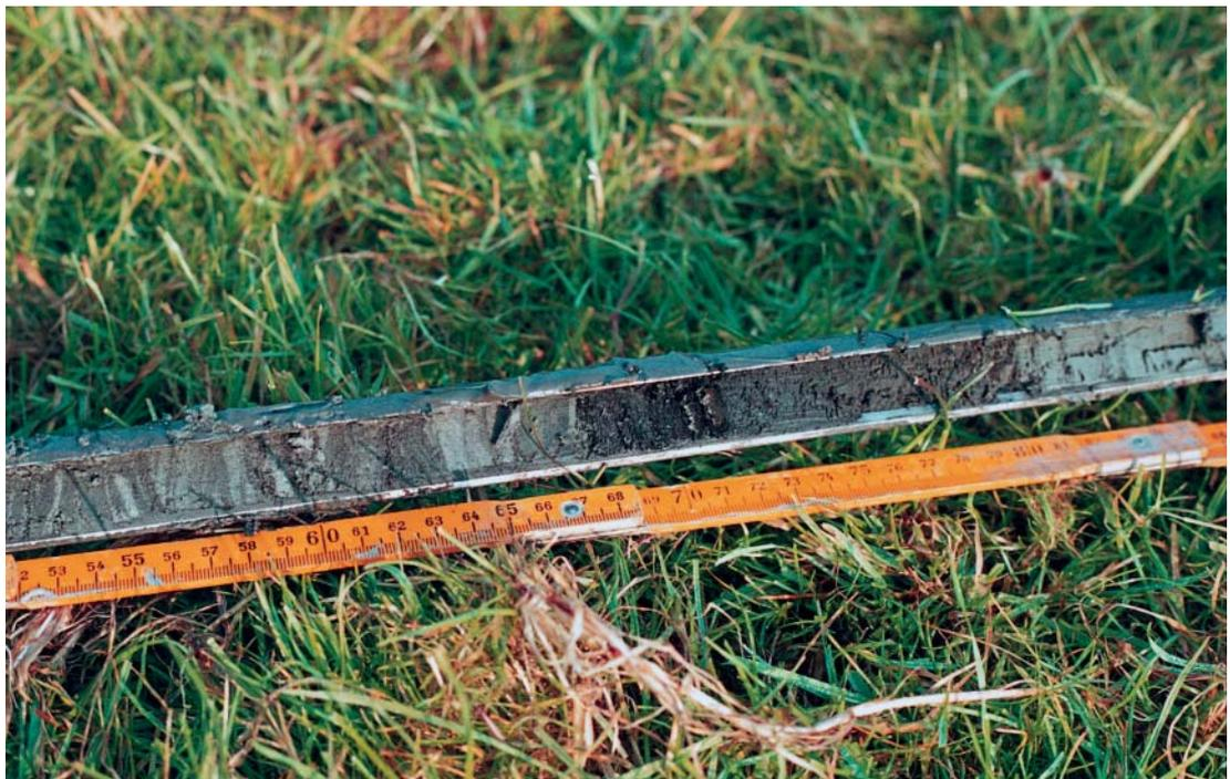
Abbildung 2: Aus dem Bohrkern werden die Sachdaten zu Schichtenabfolge, Korngröße etc. erhoben
