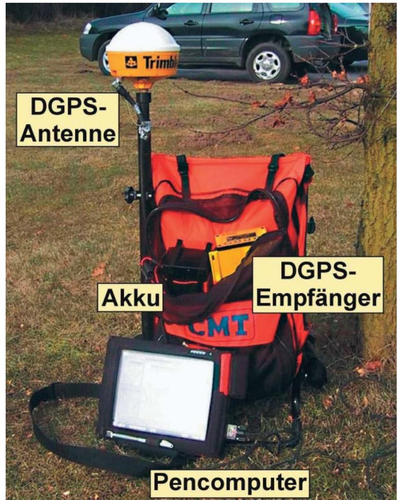
Abbildung 1: Ausrüstung zur modernen geowissenschaftlichen Landesaufnahme – PEN-Computer und DGPS-Empfänger
