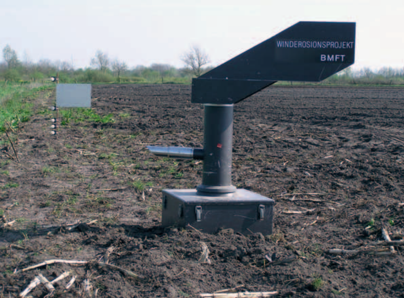
Bild 63: Sedimentfalle (Suspended Sediment Trap (SUSTRA)). Das Sediment wird im Inneren der Falle von einem Sammelgefäß aufgenommen. Der Sedimentsammler steht auf einer Waage, die die Gewichtsänderung im Gefäß kontinuierlich erfasst. Die Messwerte werden von einem Datenlogger aufgezeichnet. (Foto: R. DUTTMANN)
