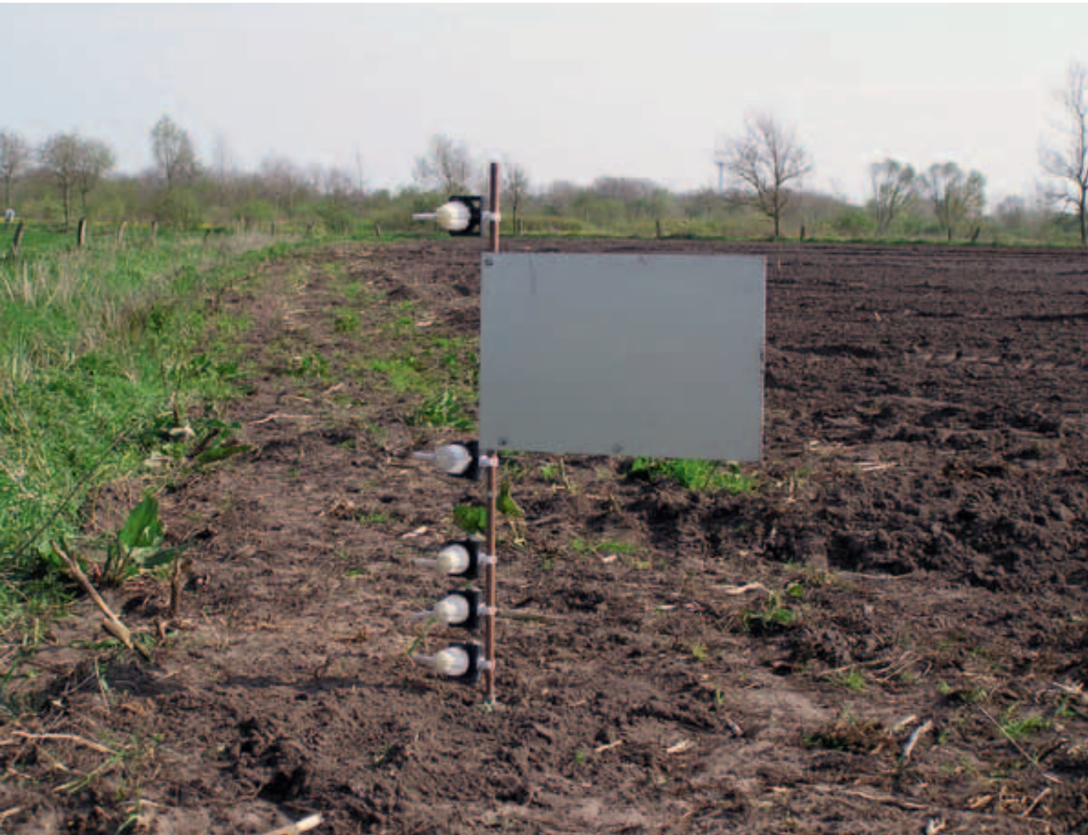
Bild 62: Sedimentfalle (Modified Wilson and Cooke (MWAC-)Sampler). Die Sammelgefäße sind in unterschiedlichen Höhen über dem Boden angebracht. Eine Windfahne sorgt für die ständige Orientierung der Auffangöffnungen in Windrichtung. (Foto: R. DUTTMANN)
