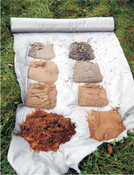
Proben einer hydrogeologischen Spülbohrung aus verschiedenen Horizonten
